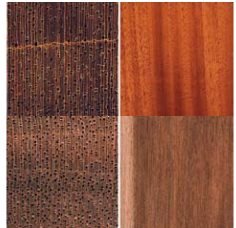
Bei der Identifizierung geschützter Holzarten hilft die Software CITESwoodID. Hier z.B. geschütztes Echtes Mahagoni oben und Andiroba im Vergleich
